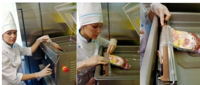
Рис.2. Демонстрація майстром виробничого навчання принципу роботи з вакууматором
