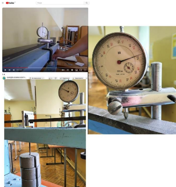
Рис. 2. Відеофрагменти роботи лабораторного обладнання (шкала мікрометра в різних режимах навантаження – вимірювання стріли прогину в роботі «Визначення модуля Юнга по згину стержня»). Усі відеофайли розміщено на YouTube-каналі за посиланням https://www.youtube.com/@user-uj3jx1mq3r/videos .
