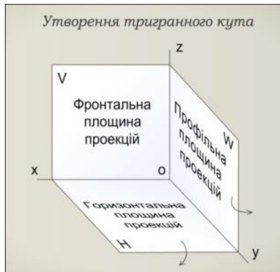
Рис. 1.42. Система площин проєкцій
