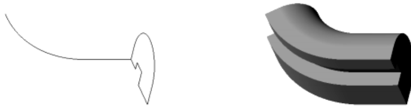
Рис. 1.70. Ескіз перетину, напрямна і елемент по траєкторії
