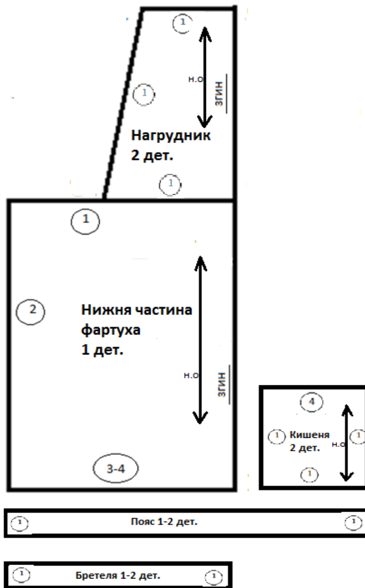
Рис. 3.56. Лекала фартуха з відрізним нагрудником
