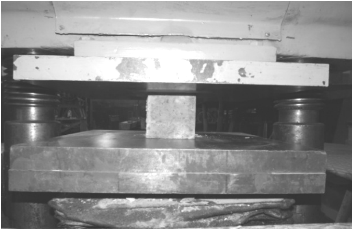
Рис. 1. Випробовування бетонних кубиків на стиск
